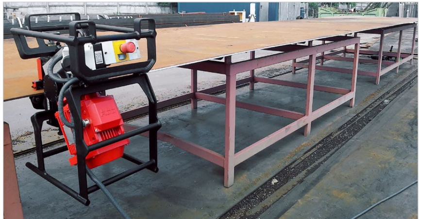
ABM-14 Loopt automatisch langs de plaat
