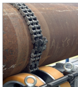
Verstelbare ketting (ø 200-1000 mm) zorgt voor een positieve axiale rotatie
