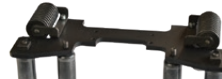
Afschuin hulpstuk voor ronde plaat Minimale radius buiten R=1000 mm Minimale radius binnen R=1000 mm Max. afschuin breedte 19 mm Product code: ZSP-0539-10-00-00-0
